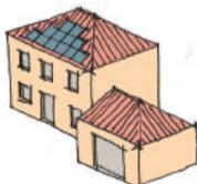
Les formes non homogènes pour éviter les cheminées, fenêtres de toit et tout autre élément technique, semblent relever d'une conception aléatoire.
